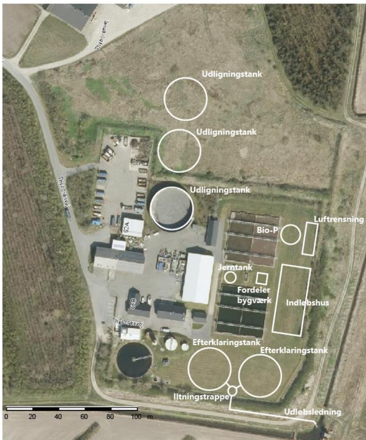
Figur 3.4: Luftfoto med placering af eksisterende anlæg på Harbøre Renseanlæg og nye anlæg ved udbygning af rensesanlægget.
